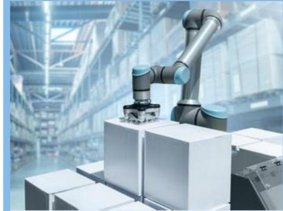
人協働ロボット\*がパレットへの積み付け、バラシ作業を行なう。
