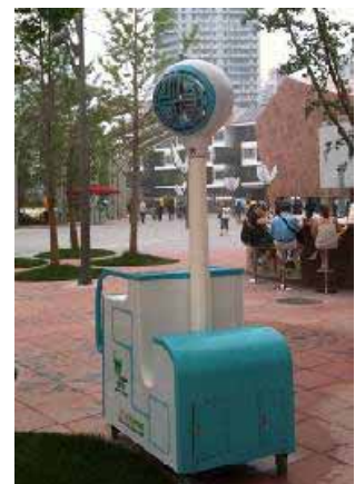
移動式「ミスト冷房」器。霧の気化熱で温度を下げる。暑さはこれからが本番。活躍が期待される。(都市実践例ゾーン)
