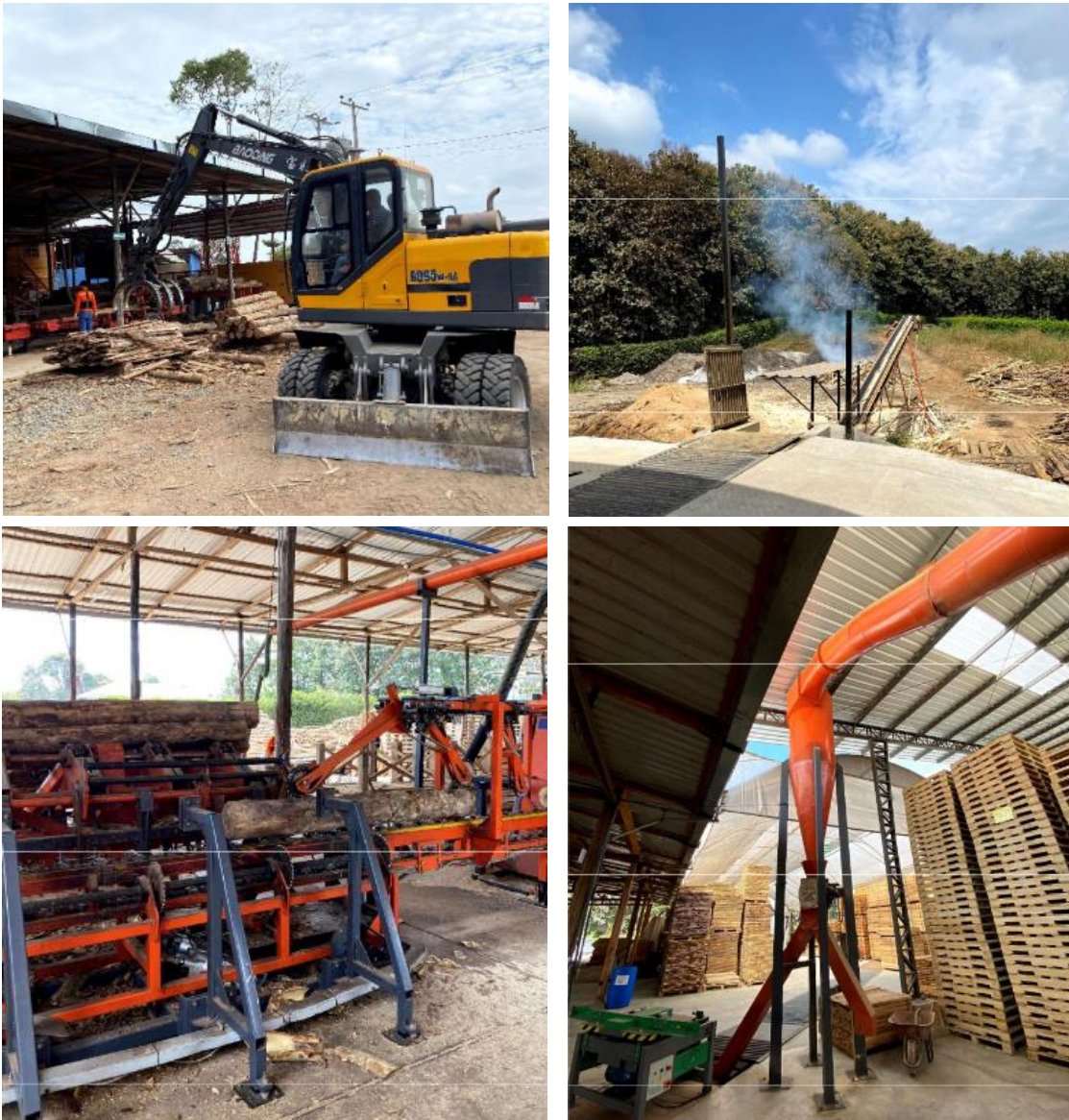
Figura 17: Fotografías de la industria: transporte interno de madera en el patio de troncos (arriba a la izquierda), patio de residuos de madera (arriba a la derecha), procesamiento (abajo a la izquierda), sistema de aspiración de partículas (abajo a la derecha)
